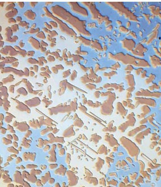
双相不锈钢，使用40%氢氧化钠水溶液电解腐蚀微分干涉对比，100x
