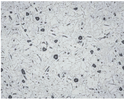
图11: 铝-硅铸件用OP-S悬浮液抛光过长, 硅析出物出现明显浮雕, 放大100x。
