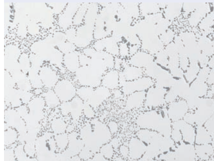
图10: 组织如图9所示, 但是用OP-U悬浮液进行精抛光。基底金属精抛后, 共晶体具有更高的对比度, 放大200x。
