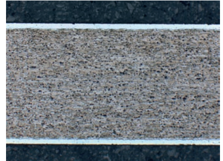
电镀板, 芯: 铝合金2024, 电镀: 99.5%铝, Dix和Keller浸蚀, 放大50x。
