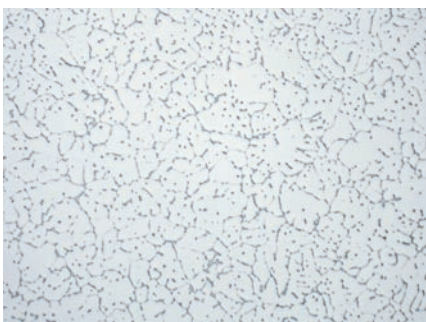
图3: 铝合金2024, 铸造, 晶界上发生共晶析出, 未浸蚀, 放大200x。
