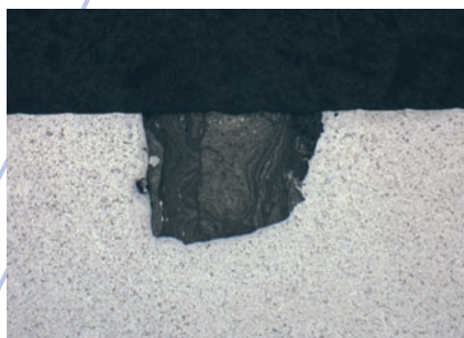
图2：铝压铸铸件表面的氧化物
