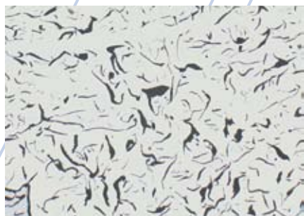
图1: 带片状石墨的灰口铸铁: 抛光不足 200x
