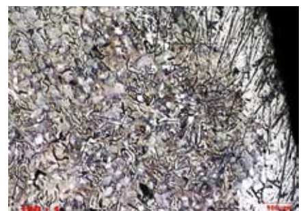
图16: 使用金刚砂砂纸精磨灰口铸铁, 仍显示有刮擦痕迹。
