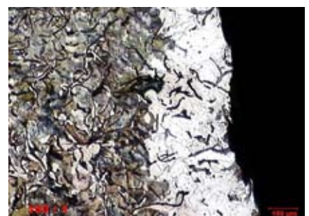
图17: 同图16材料。使用金刚石在MD-Largo上进行精磨制备, 显示良好的边角防护效果。
