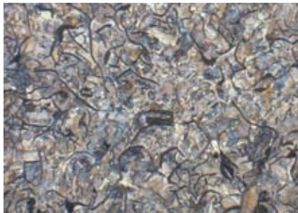
图4:珠光体基体下带片状石墨的灰口铸铁 200x
