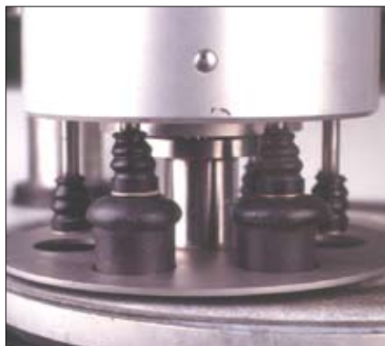
图13: 试样夹具, 用于铸造生产线上质量控制样品的半自动抛光
