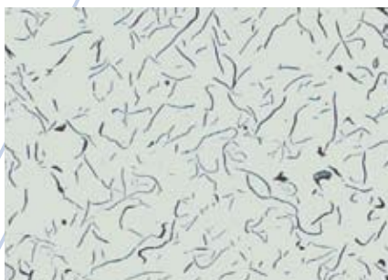
图2: 与图1相同的铸铁, 抛光正确 200x
