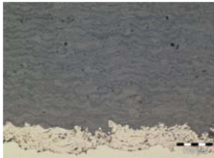
图6: 带有NiCr粘合层的APS涂层, 及氧化钛顶部涂层
