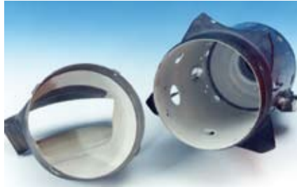
带有APS绝热涂层的燃烧室, 粘合涂层NiCrAlY, 顶部涂层ZrO 2 + Y 2 O 3
