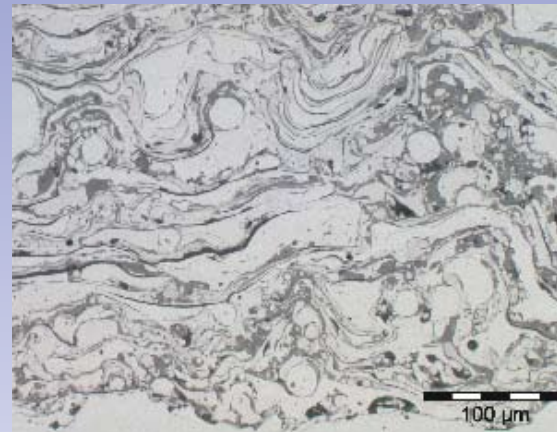
电弧金属喷涂涂层，显示灰色的氧化物和未熔化的圆形颗粒
