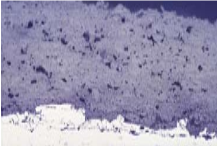
图10: 与图9相同的涂层, 冷镶嵌
