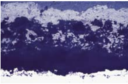
图9: 陶瓷喷涂涂层在热压缩镶嵌过程中受损
