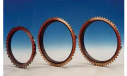
使用铝对铸铁同步器锁止环进行火焰喷涂，以增加其耐磨性能
