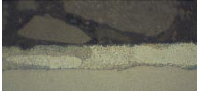
图10: 涂层与图9相同，更高倍放大时，呈片状共晶结构，1000 x
