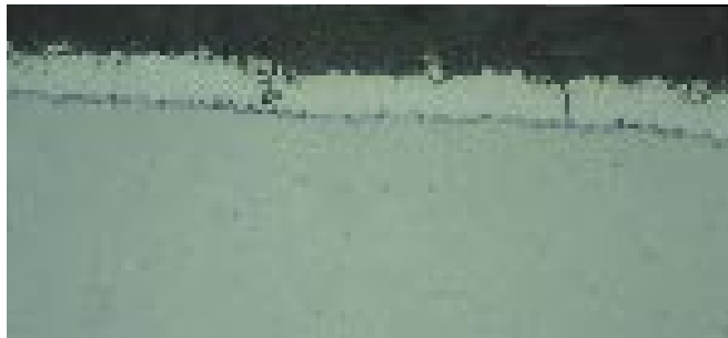
图11: Galvaneal涂层，用1%奈塔尔硝酸乙醇腐蚀液蚀刻， \alpha ，1000 x
