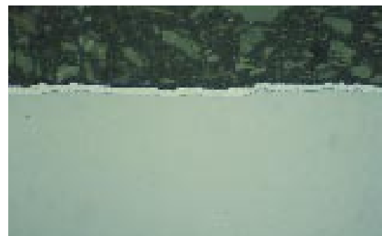
图5：电镀锌涂层，抛光至1微米，采用纯酒精进行最终清理/抛光，1000 x
