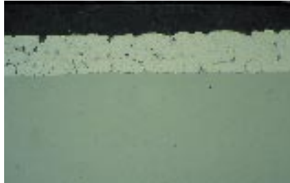
图1: 镀锌钢, 用1%奈塔尔硝酸乙醇腐蚀液蚀刻处理, 500x
