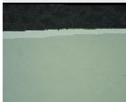
图8：用酒精处理后的热浸涂层，500 x
