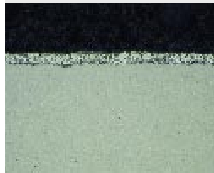
图7：用水处理后的热浸涂层，500 x
