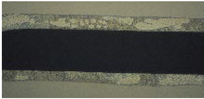
图9: Galvaneal涂层，用0.5%奈塔尔硝酸乙醇腐蚀液蚀刻，一级树枝状结构，500 x
