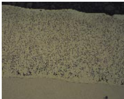
图6：后加工的镀锌涂层，采用0.5%奈塔尔硝酸乙醇腐蚀液蚀刻，基体金属边缘为 \gamma 相，锌基体中有大 \delta 柱体，200 x。
