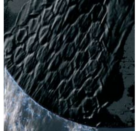
有了3D表面，喷入六边形之间通道的所有水流均将被传送到切割区域，因此使工件冷却更为高效
