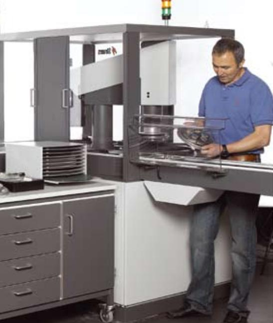
蠕动泵确保悬浮液和润滑剂的精确计量，内置的重量传感器不断检测液体水平。必要时，可在制样过程中使用手动加液按钮，加入额外的润滑剂或悬浮液
