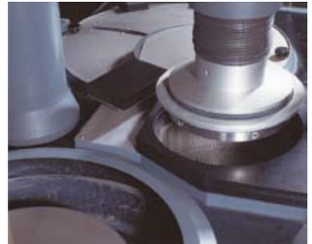
5. 研磨结束后，试样座被送入清洗室
