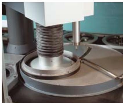
4. 正在进行研磨，下一个试样座已做好提升准备
