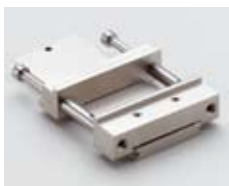
试样夹具座CATSI, 通用 最大打开: 60 mm
