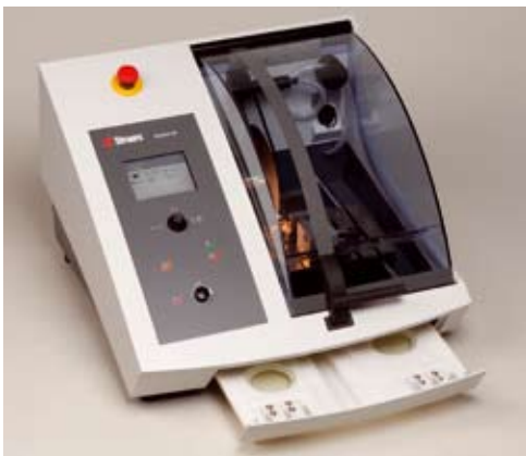
内置循环冷却水箱可以储存3.5 l冷却液
