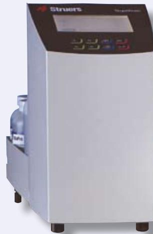
TargetDoser 自动加料装置，为 TargetMaster 提供各种制备方法，并提供制样所需的悬浮液/润滑剂/清洁剂等。TargetDoser 配有 7 台蠕动泵和 13 种预编程方法，并可存储 200 种用户自定义方法。
