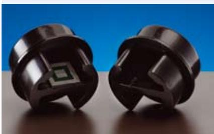
试样座——横截面磨削试样夹具。有 30 mm（05756914）和 40 mm（05756908）直径可选
