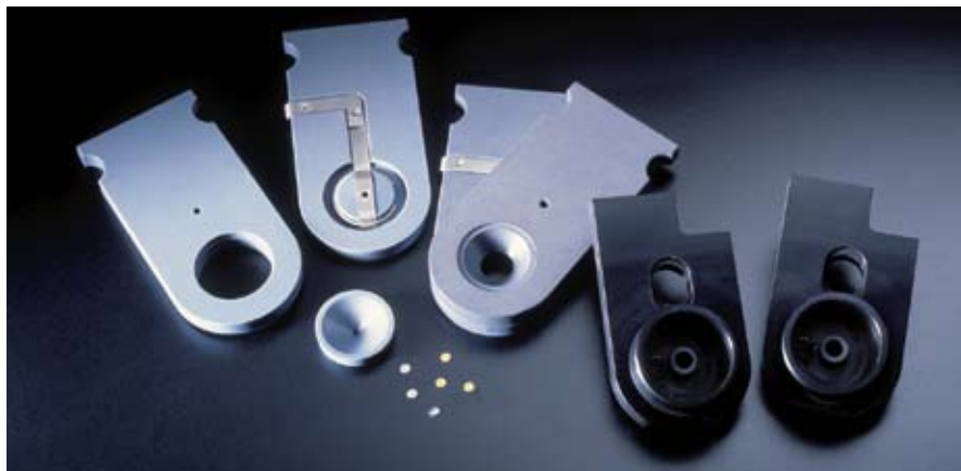
如图所示为3毫米试样终磨薄的试样夹具座，带10毫米直径试样安装孔用于预磨薄或电解冲孔，以及一组喷嘴座。图中还可以看到铂连接器和滑动试样夹具。
