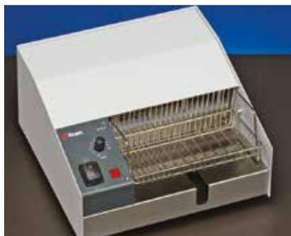
Drybox de Struers contrôle la température au cours du processus de durcissement et permet d'optimiser vos résultats d'enrobage
