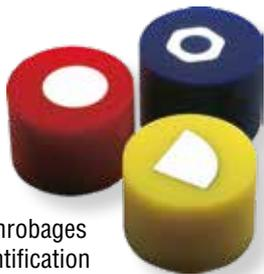
Teintez vos enrobages pour une identification facile grâce à AcryDye de Struers pour la coloration des résines d'enrobage à froid acryliques.
