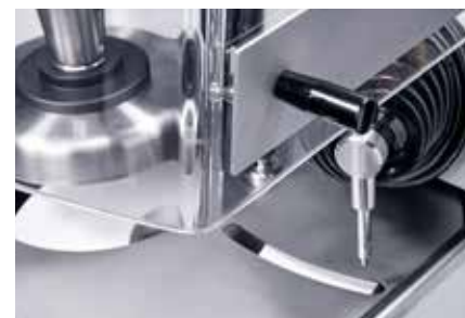
Sur AbraPlan-30, des meules de 356 mm de diam. sont utilisées, ce qui permet de préparer des porte-échantillons jusqu'à 200 mm de diam., et ainsi d'assurer la préparation des échantillons grands ou nombreux en un temps très court.
