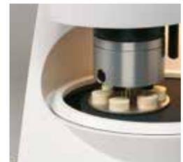
*Le porte-échantillons avec orifices rectangulaires peut contenir des échantillons jusqu'à 70x53 mm*
