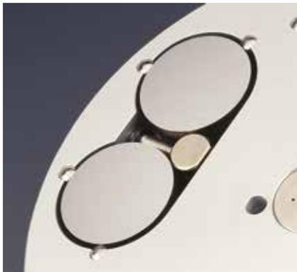
*Bridage double - deux échantillons sont bridés à l'aide d'une seule vis*
