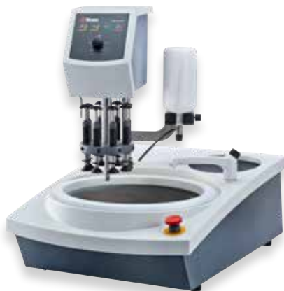
LaboForce-Mi est un porte-échantillons motorisé automatique pour la production des lames minces, des lames minces polies et des échantillons polis de matériaux minéralogiques. La force est appliquée par des ressorts pouvant être réglés individuellement.
