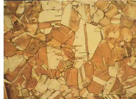
Cuivre pur. Echantillon attaqué au chlorure cuivrique et à l'ammoniac. Grossissement 100x. Echantillon
