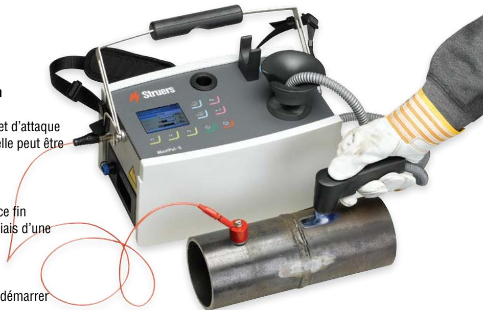
Eclairage LED intégré pour un contrôle visuel optimal
