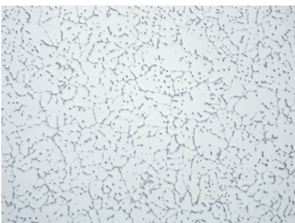
Fig. 3: Alliage d'aluminium 2024, coulé, montrant une précipitation eutectique sur les limites de grain, non-attaqué, 200x.
