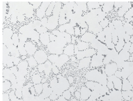
Fig. 10: Structure comme à la Fig. 9, mais après polissage fin avec suspension OP-U. La matrice est bien polie et l'eutectique a plus de contraste, 200x.
