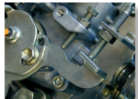
Section d'une pièce de construction mécanique avec des composants en aluminium coulés.
