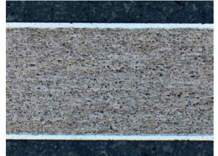
Feuille plaquée, cœur: alliage d'aluminium 2024, revêtement: aluminium 99,5%, attaqué à Dix et Keller 50x.
