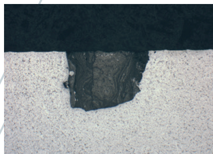
Fig. 2: Oxyde dans la surface d'une coulée sous pression en alliages d'aluminium, 50x.
