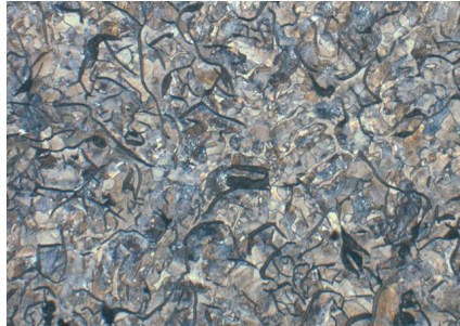
Fig. 4: Fonte grise avec graphite lamellaire dans matrice perlitique 200x
