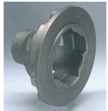
Fig.10: Carter de différentiel en fonte ductile
