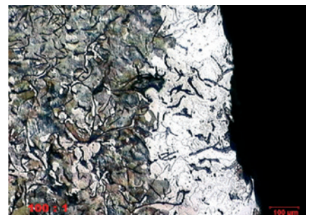
Fig.17: Pareil que la fig. x, après prépolissage fin diamanté sur MD-Largo, montrant une bonne netteté des bords
