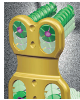
Fig. 5: Vis et plaquette d'os, oxydées électrochimiquement pour le codage couleur. Les couleurs sont le résultat des différentes épaisseurs de la couche oxydée.
