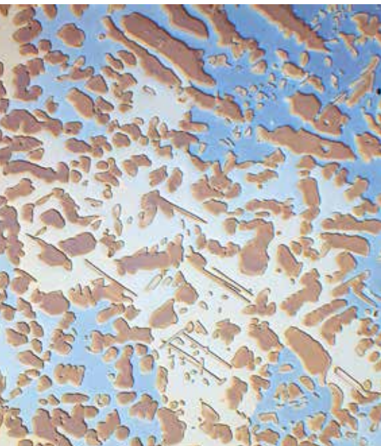
Acier inoxydable duplex, après attaque électrolytique avec une solution aqueuse d'hydroxyde de sodium 40%. Contraste interférentiel différentiel, 100x.
