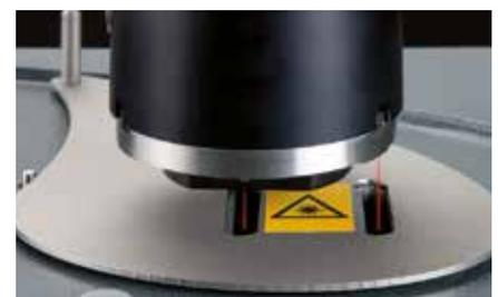
Le système de mesure double laser intégré offre une précision du système de ± 5 µm
