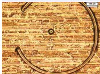
Dépôt physique en phase gazeuse (PVD) de chrome sur acier, foyer de corrosion possible, 50 x
