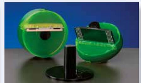
Insertion de moule de 40 mm (TARIN), entièrement enrobée et partiellement enrobée
