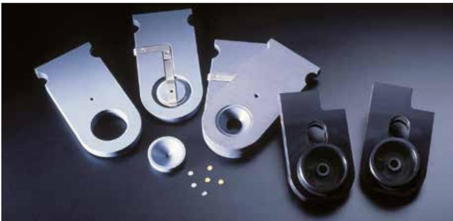
*Porte-échantillons pour échantillons de 3 mm pour l'amincissement final, avec un trou de 10 mm de dia. pour le pré-amincissement ou la découpe et un jeu de porte-buses, le connecteur de platine et la fixation coulissante de l'échantillon.*
