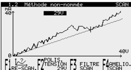
Tous les matériaux ne montrent pas une courbe de densité du courant aussi facile à analyser que celle montrée ci-dessus. Des fonctions de filtre et d'amplification sont donc intégrées dans TenuPol-5.
