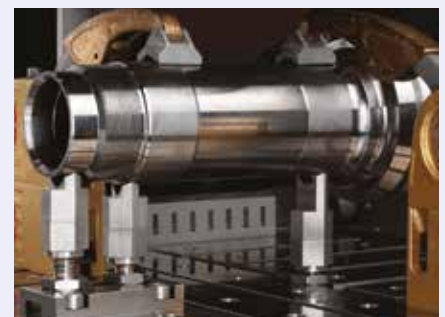
Einstellbare Unterbaustempel (drehbar, horizontal und vertikal verstellbar) und vertikales Spannsystem (Verlängerungsarm und Höhenaufbau optional).
