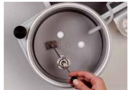
Deckel zum Aufkleben von Dünnschliff-Proben
