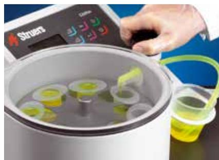
Leichtes Befüllen der Einbettformen.
