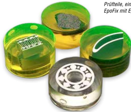
Prüfteile, eingebettet in EpoFix mit EpoDye.
