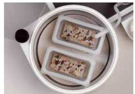
Große Vakuummkammer für große Proben.
