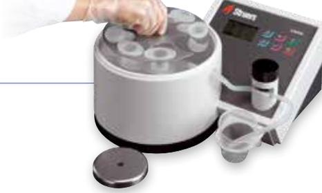
Schnelles und leichtes Imprägnieren mit dem Struers Halter für Einbettformen
