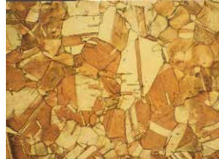
Reines Kupfer. Probe geätzt mit Kupferchlorid und Ammoniak. Vergrößerung 100 x
