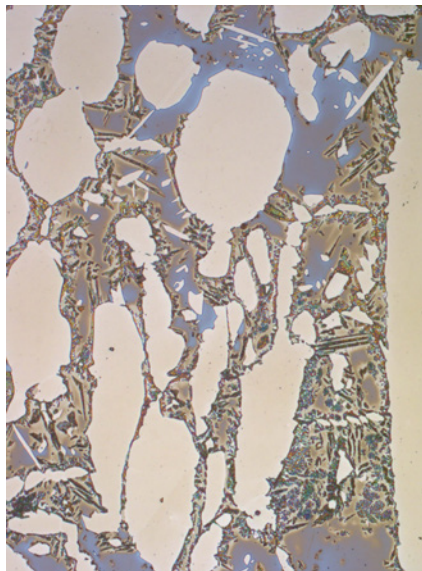
Abb. 10: Gefüge eines Schmiedeteils aus Duplex Stahl, elektrolytisch geätzt mit 40%iger Natronlauge zeigt den Ferrit blau, Austenit weiß und feine Nadeln aus Sigma-Phase.
