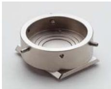
**Probenhalter CATRE, für zylindrische Proben**Max. 40 mm  $\emptyset$
