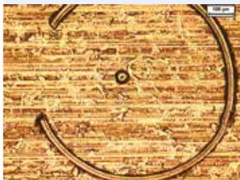
*Chrom PVD Schicht auf Stahl, mögliche Korrosionsstelle, 50 x*
