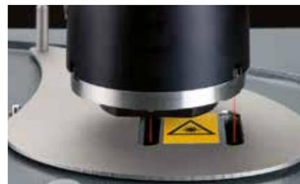
*Genauigkeit von ± 5 µm durch integriertes duales Laser-Messsystem*
