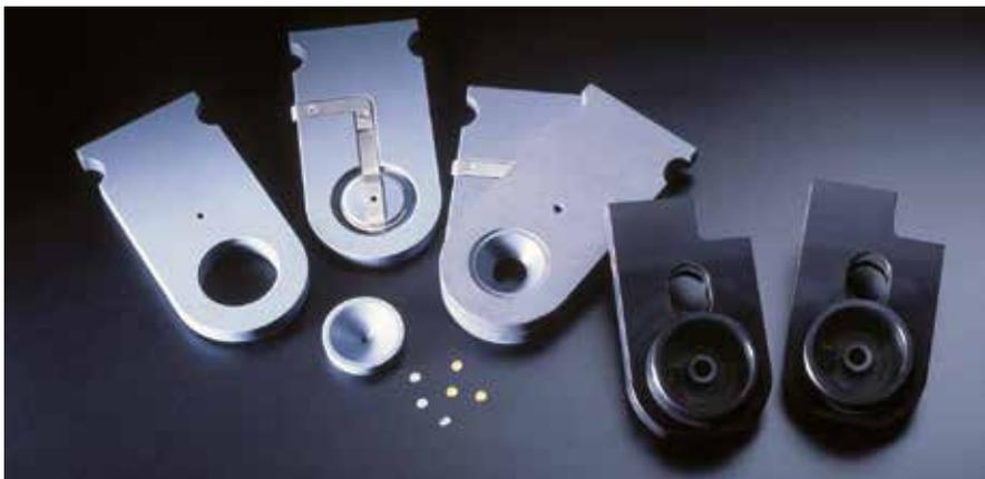
Ein Probenhalter für 3 mm Proben für das Enddünnen, mit 10 mm Loch für das Vordünnen oder elektrolytisches Stanzen und ein Düsensatz. Der Platinkontakt und die verschiebbare Blende sind deutlich zu sehen.
