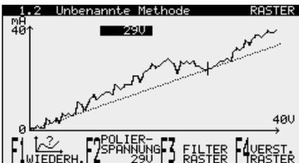
Strom-Dichte-Kurven sind nicht immer so leicht analysierbar, wie im obigen Diagramm dargestellt. Eine zusätzliche Filterfunktion ermöglicht, störende Informationen weitestgehend zu unterdrücken.
