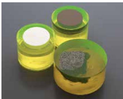
Struers fluoreszierender Farbstoff erleichtert die Erkennung von Poren und Rissen
