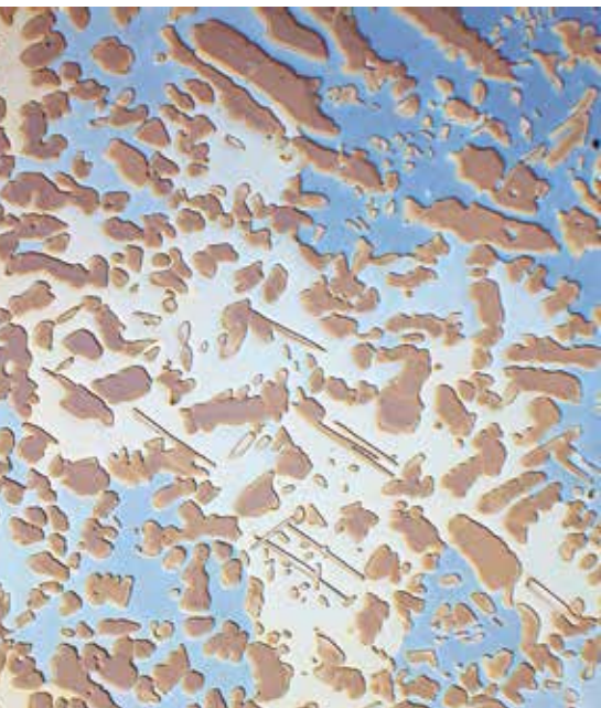
二相ステンレス鋼、40%水酸化ナトリウム水溶液による電解エッチング。微分干渉コントラスト、100倍
