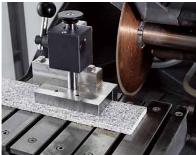
低くて規則的な形状に適した、垂直クイッククランピング工具。
