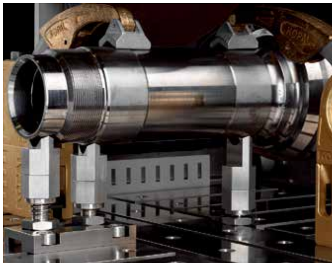
サポートブロック、ライザーブロック、延長アーム、クラウンを使用した垂直クランピング工具。
