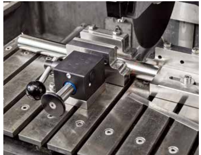
連続的な切断に角柱押さえ部付のクイッククランピング工具と調整可能なストップ
