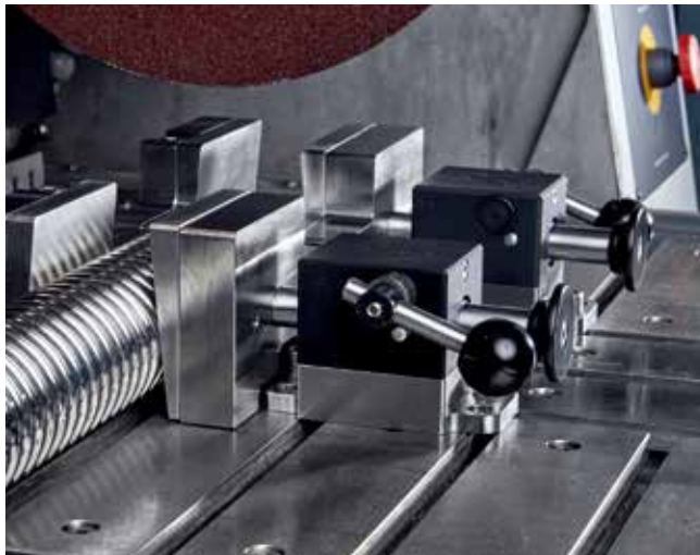
繰り返しの連続切断に適した溝付きの押さえ部を使用したクイッククランピング工具左 12 mm。
