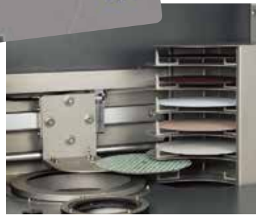
ステップ3: ディスクがディスクエレベーターのポケットに挿入されます
