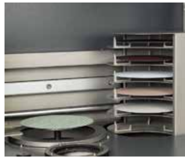
ステップ1: MD-ディスクの中央部分で交換される研磨ディスクが押し上げられます。
