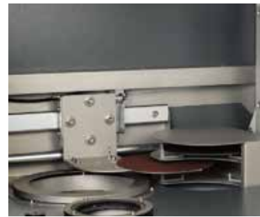
ステップ4: 次のMD研磨ディスクがエレベーターから抜き取られ、MD-ディスクに運ばれます
