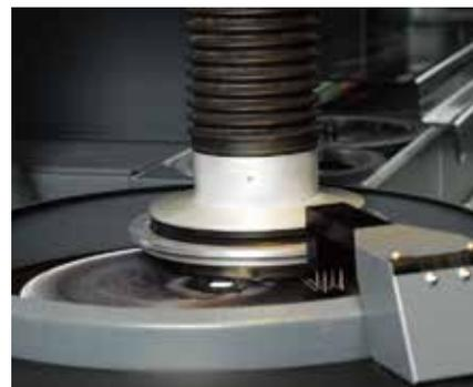
6. 精研磨後、試料ホルダーを琢磨工程へ搬送
