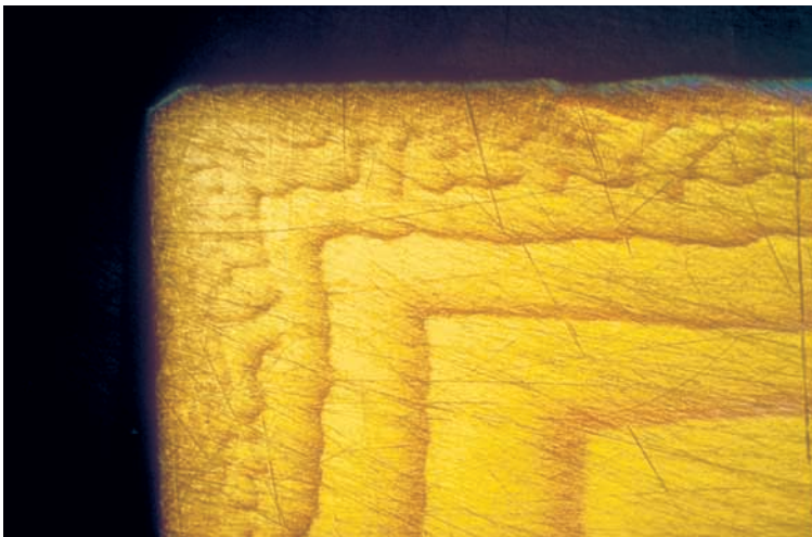
1. 軟質で延性の高い鋼上のスミアリング 倍率：15x、DIC
