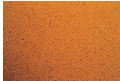
焼結炭化物 倍率：1000x DIC (微分干渉コントラスト)
