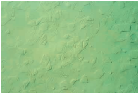
1. 短い線状変形、一種類の粒界に限定。
