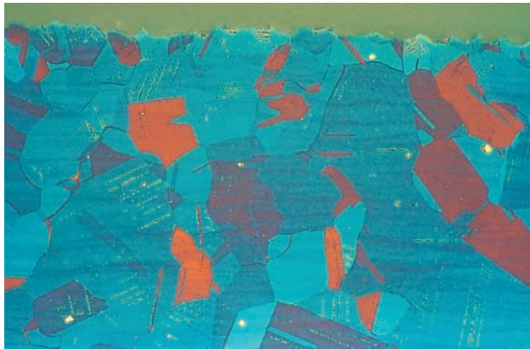
2. 良好な縁の保持 ステンレス鋼 倍率：500x 腐食剤：ペラハ I
