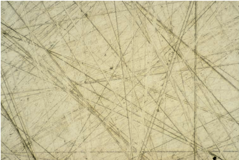
FG後の表面。PGによる条痕がまだ見られる。 倍率：200x
