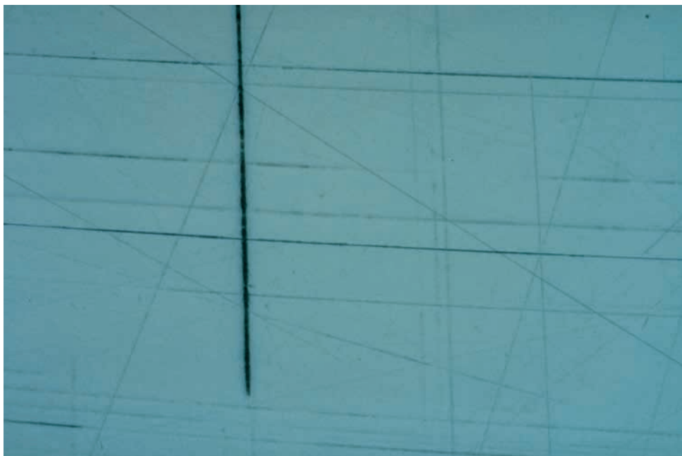
ダイヤモンド琢磨後の表面。FGでの条痕がまだ残っている。非常に深い縦方向の条痕はPGから残っていた可能性がある。 倍率：200x
