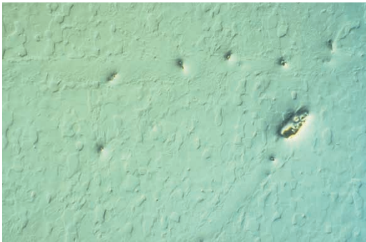
2. 最終琢磨後のラップ痕跡： 非常に深い圧痕が依然見られる。また、ラップ痕跡に沿った表面の変形も見られる。
