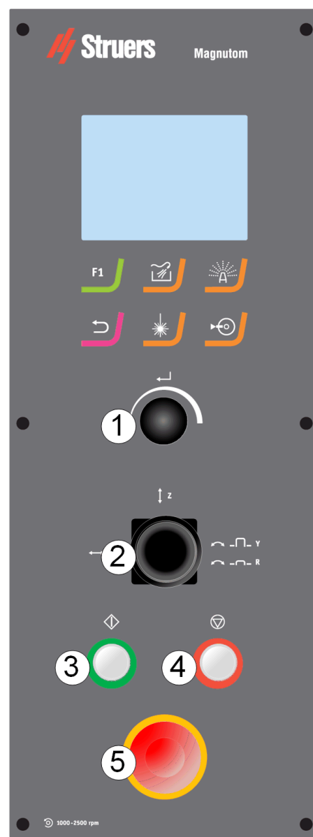
Ovládací panel stroje Magnutom-5000 s otočným stolem.
