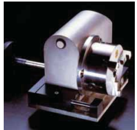
Optionale Dreibackenspannvorrichtung zum Trennen sehr harter Werkstoffe
