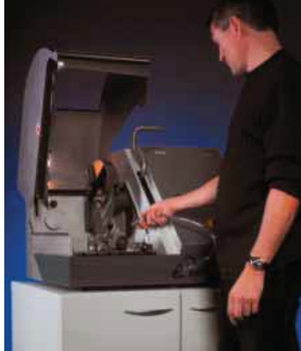
Bedienerfreundliche Anbringung von Reinigungsschlauch und Steuerventil an der Front
