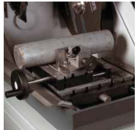
Verstellbarer Trenntisch zum Trennen Viderähnlicher Proben (Zubehör)
