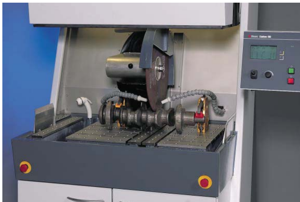
Außergewöhnlich große und zugängliche Trennkammer. Selbst die größten Werkstücke können einfach auf dem Trenntisch plaziert werden
