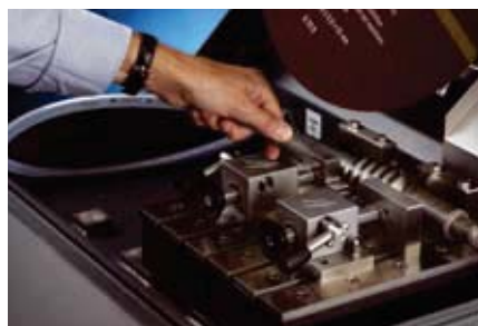
Commodité intégré tuyau de rinçage pour le nettoyage du compartiment de tronçonnage
