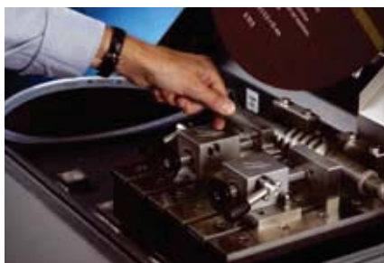
Anwenderfreundlichkeit: Spülschlauch zur Reinigung des Trennraumes.
