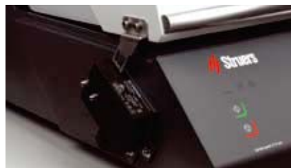
Sicherheit: Schutzhaubensperre während des Trennvorgangs.
