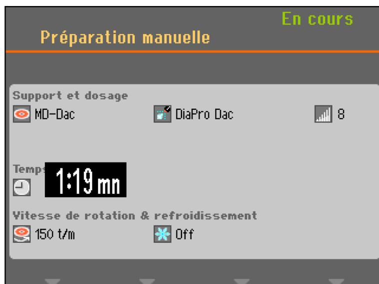
Le disque et le dosage s'arrêteront automatiquement lorsque le temps programmé est écoulé.
