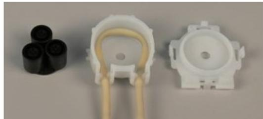
5. Ziehen Sie den Novopren-Schlauch ab.
