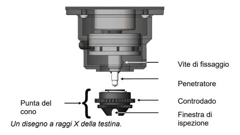
La vite di fissaggio mantiene in posizione il penetratore. La punta del cono agisce come serraggio che fissa il campione contro l'incudine.
