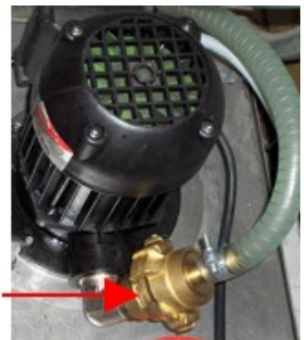
A ポンプ排水口
