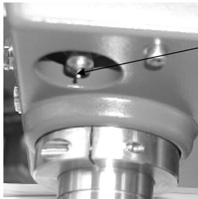
Válvula de Saída de Descarga
