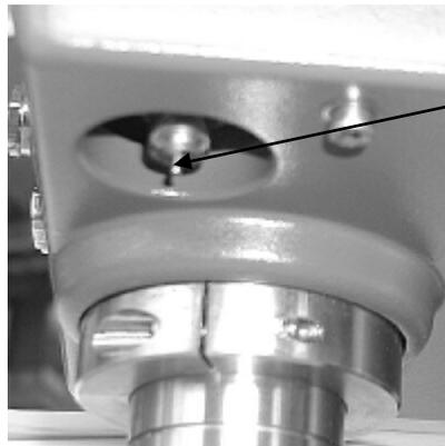
Válvula de Saída de Descarga
