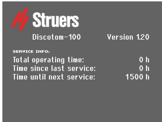
Después de 1000 horas de funcionamiento (o un número determinado de meses), se mostrará un mensaje emergente para recordarle que debe programarse una comprobación de servicio. Después de 1500 horas de funcionamiento se habrá excedido el tiempo y el mensaje emergente cambiará para avisar al usuario de que se ha superado el intervalo de servicio recomendado. Póngase en contacto con el servicio técnico de Struers.
