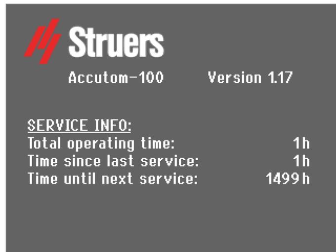
Cuando enciende la máquina, en la pantalla se muestra la configuración y la versión del software instalados.
