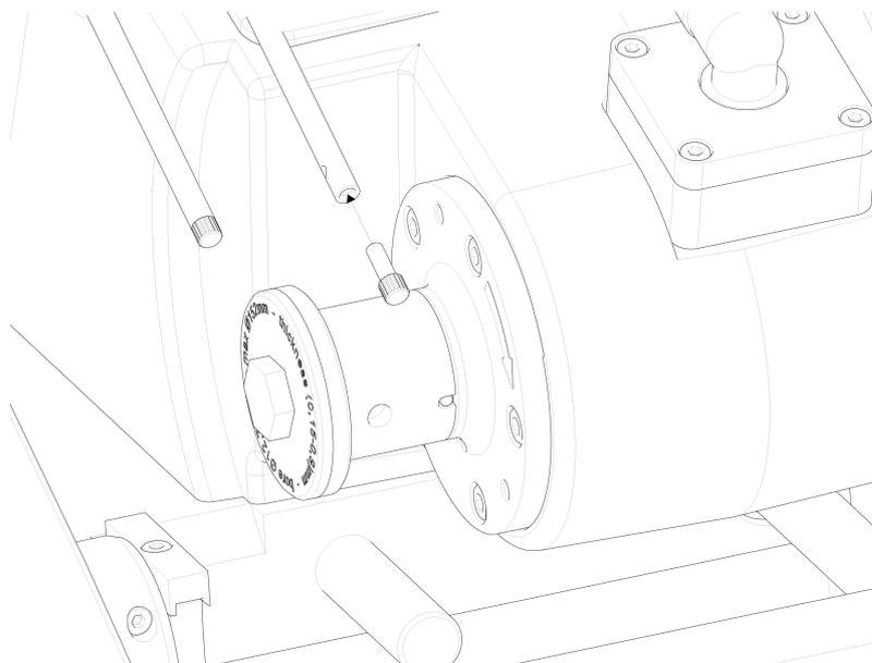
1. Vuelva a colocar el tornillo pequeño en el extremo de la boquilla derecha con el tornillo largo.
