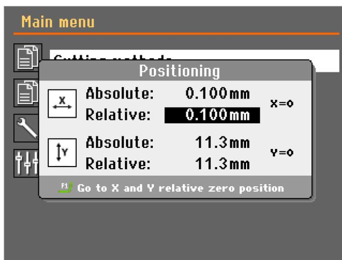
1. Utilice el botón de accionamiento mantenido y las teclas de posicionamiento para colocar la pieza en la posición de inicio correcta, cerca del disco de corte.
