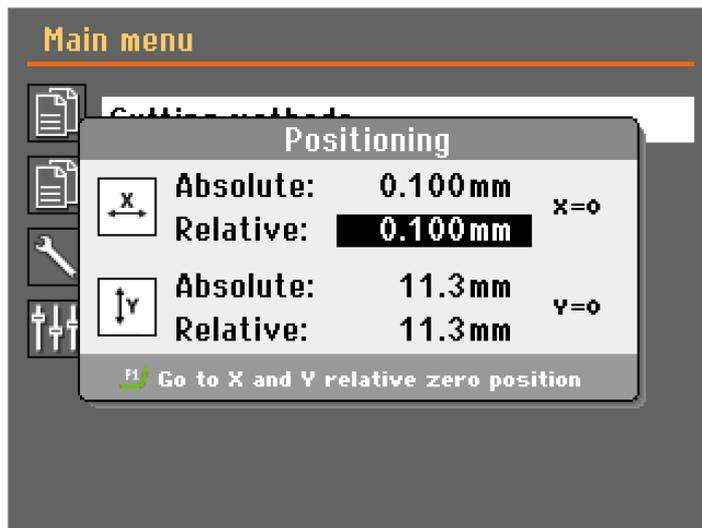
El menú **Positioning** (Posicionamiento) se muestra al presionar las teclas de posicionamiento.
