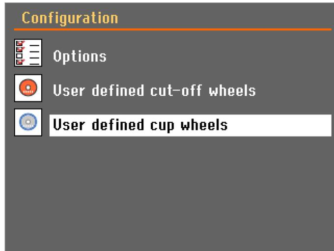
1. En la pantalla **Configuration** (Configuración), seleccione **User defined cup wheels** (Copas de diamante definidas por el usuario).
