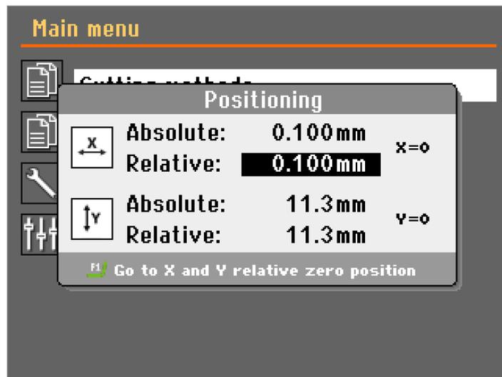
1. Utilice el botón de accionamiento mantenido y las teclas de posicionamiento para mover la muestra.
