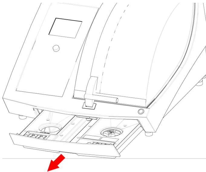
1. Deslice suavemente hacia afuera el tanque de refrigerante.
