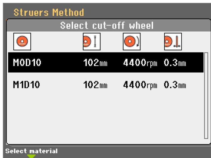
6. Seleccione un disco de corte de la lista. La velocidad de rotación recomendada se aplicará automáticamente.
