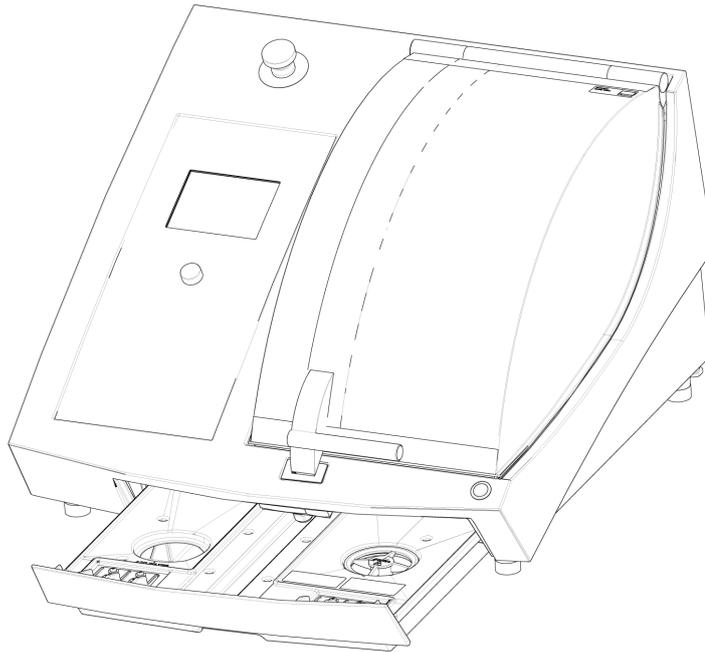
1. Asegúrese de que el tanque de refrigerante esté en posición debajo de la cámara.
