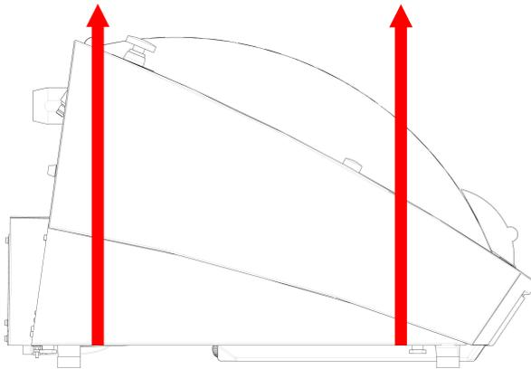
2. Coloque las correas por debajo de la máquina de modo que queden en el interior de los pies.
