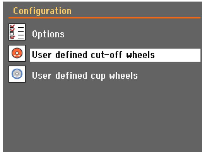
1. En la pantalla **Configuration** (Configuración), seleccione **User defined cut-off wheels** (Discos de corte definidos por el usuario).
