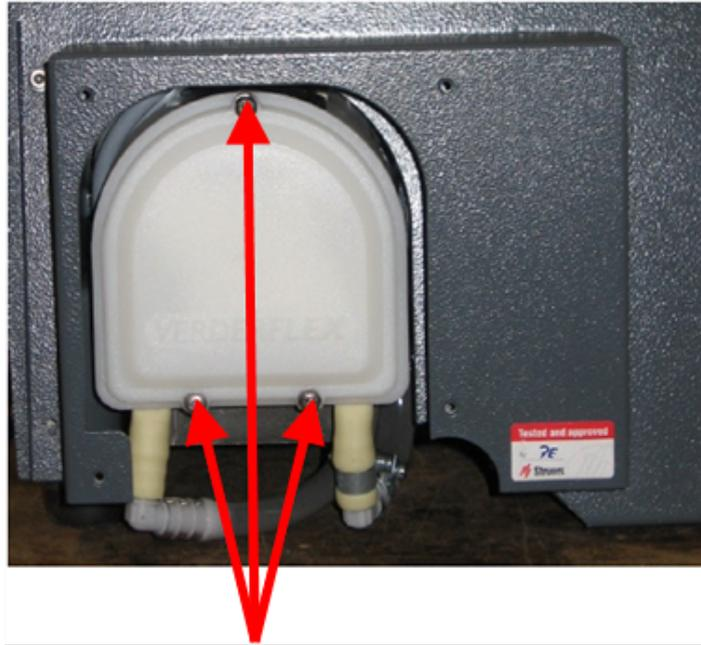
2. Retire los tres tornillos de la cubierta de la bomba de refrigeración.
