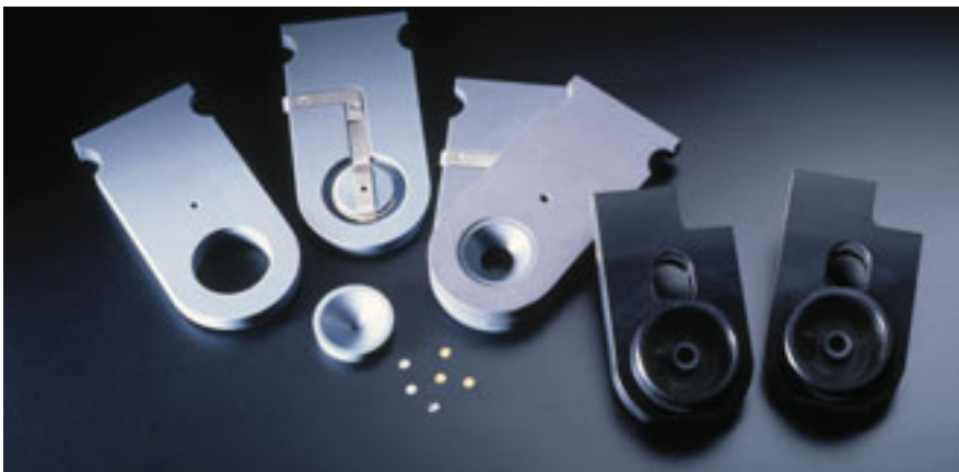
Ein Probenhalter für 3 mm Proben für das Enddünnen, mit 10 mm Loch für das Vordünnen oder elektrolytisches Stanzen und ein Düsenatz. Der Platinkontakt und die verschiebbare Blende sind deutlich zu sehen.
