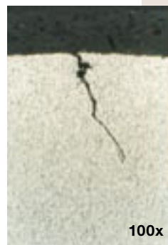
图7b: 所示裂缝的横截面图蚀刻剂: 3%奈塔尔硝酸乙醇腐蚀液
