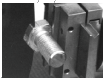
镶样之前切除螺钉头多余部分
