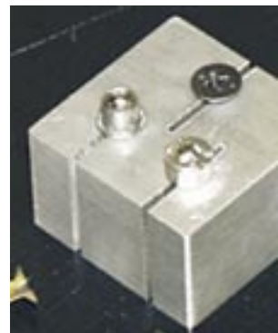
图2：螺钉切割专用试样座
