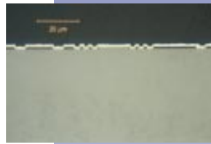
图 2: 硅片横断面, 带有各种 IC 导线。
