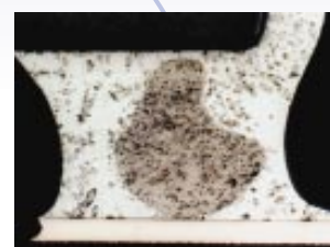
图 6: 焊料中的金刚砂微粒。
