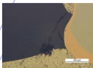
图 4: 粗磨砂纸导致的玻璃二极管断裂损伤。
