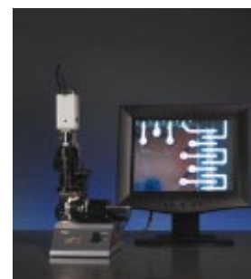
图 11: Target-Z 可见目标视频定位与测量设备
