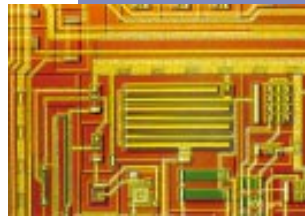
图 1: 线性集成电路详图, 位于中心部位的各种引线、晶体管、电阻、导孔和电容。
