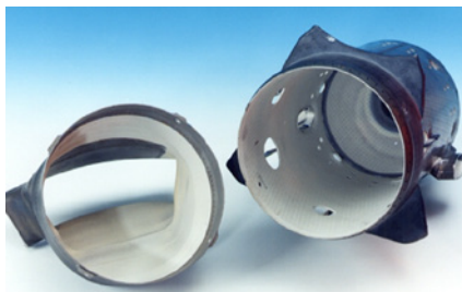
具有 APS 热障涂层、粘结涂层 NiCrAlY、表面涂层 ZrO 2 +Y 2 O 3 的燃烧室
