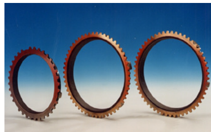
使用钨进行火焰喷涂的黄铜同步环,以提高耐磨性
