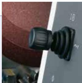
*Facilité d'utilisation parfaite: La meule de tronçonnage et les deux tables de tronçonnage automatique sont positionnées à l'aide d'un joystick à 3 axes facile d'utilisation*
