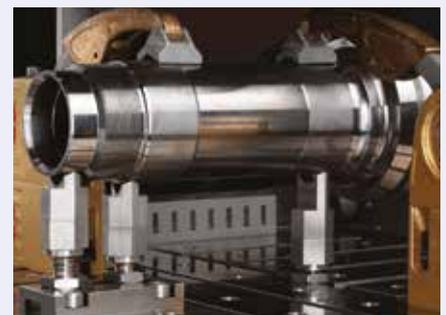
Blocs supports réglables (rotatifs, réglables horizontalement et verticalement), et étaux de bridage verticaux (Extension de bras optionnelle).
